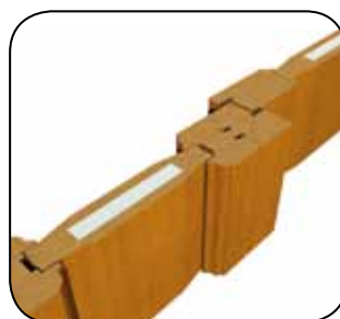
az ajtótok vastagsága és a hozzá illesztett bevilágító vastagsága egyforma
